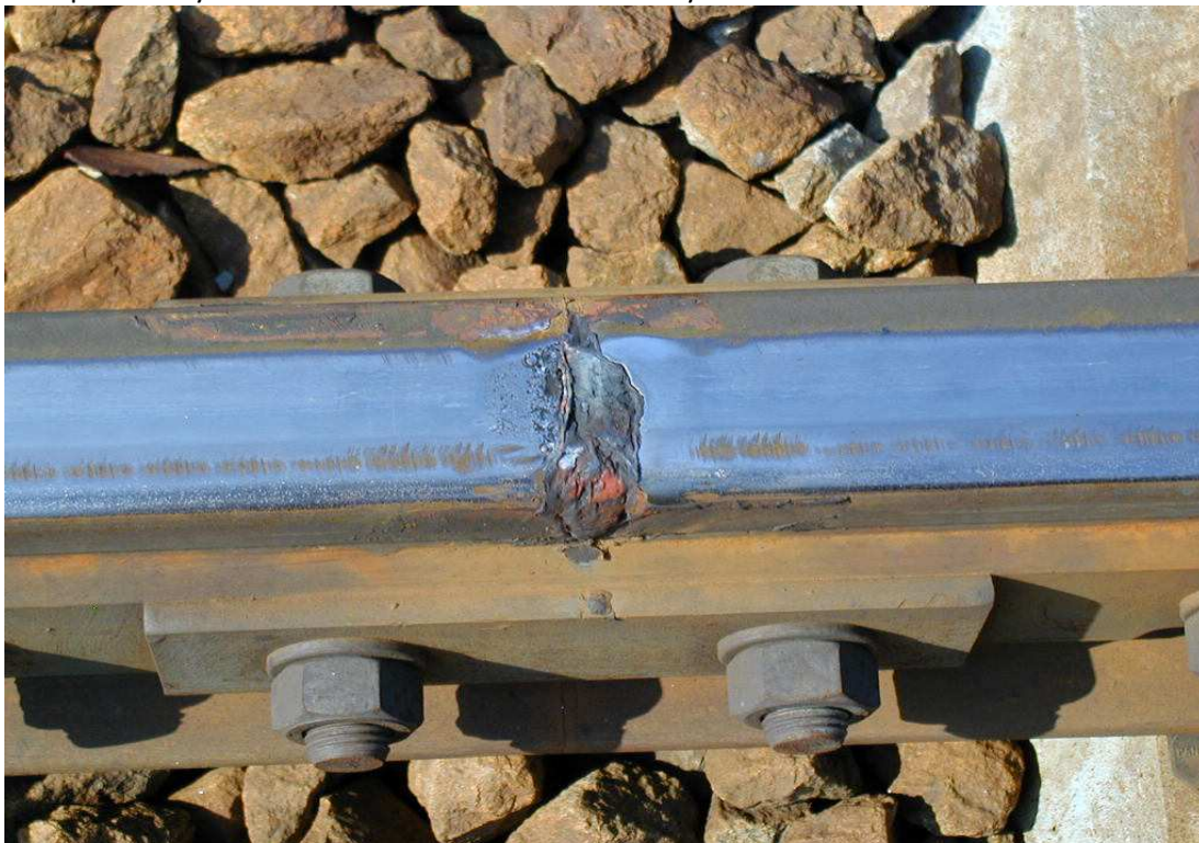
Obr: poškozený IS vlivem elektrického oblouku na styku trakčních soustav
